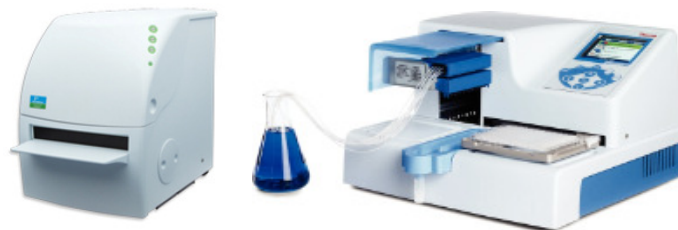
Figura 5.- Plataformas empleadas en los ensayos de set up respecto a las condiciones de pH. A la izquierda, el lector de fluorescencia EnVision Multilabel Reader y a la derecha, el dispensador Multidrop Combi Reagent Dispenser.
