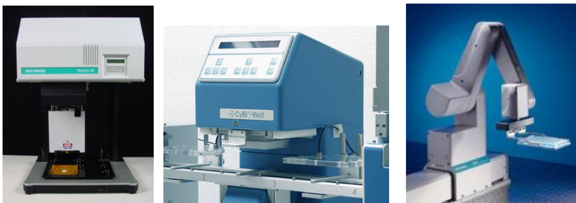
Figura 6.- Componentes integrantes de la plataforma dual con FLIPR. De izquierda a derecha, los dispensadores Multimek y Cy-bi y el ORCA Robotic System (Beckman-Coulter)
